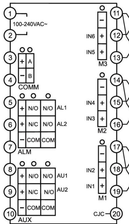
注：本图为 A、C、E 型竖式面板的式仪表接线图。
